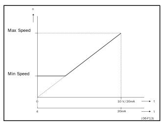
Fig. 47 Min Speed Mode = Limit.
