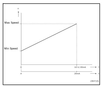
Fig. 46 Min Speed Mode = Scale.
