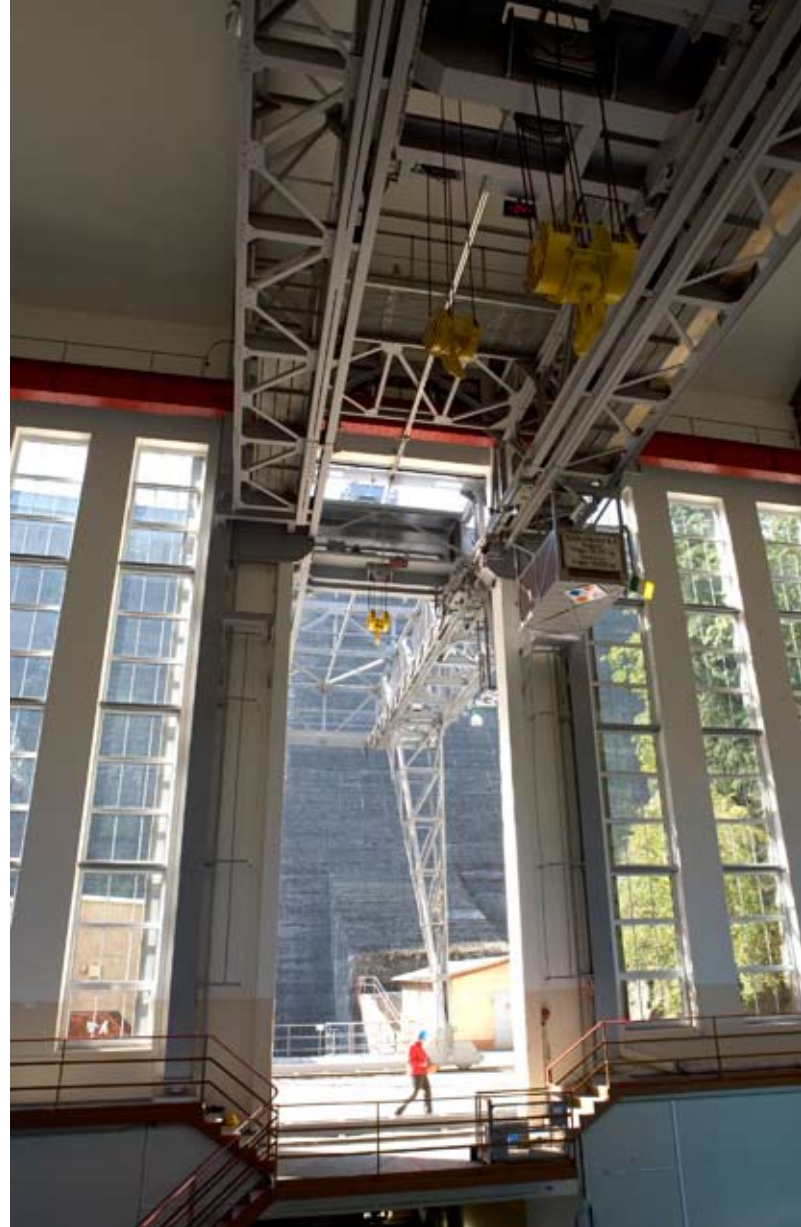
Bleiloch抽水蓄能电站对起重机的现代化改造，减少了维护，操作对用户更加友好。运行车间的两台起重机，与节流阀前岸的一台门式起重机衔接。这个方案的载重能力为100吨。
