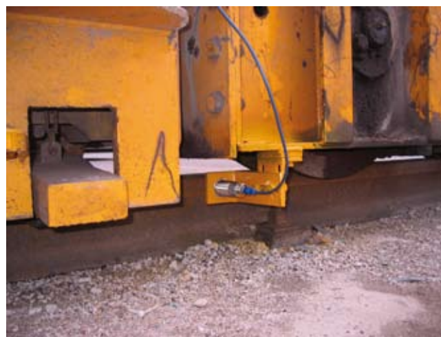
Kontakt mellan hjulflänsarna och rälsen undviks. Noggrannheten hos signalerna från de fyra avståndsgivarna som använder ultraljud är avgörande för driften.
