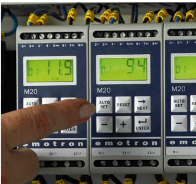
La exclusiva función de autoajuste (Autoset) del Emotron M20 define cuatro niveles de alarma, en tres segundos y con sólo presionar un botón.
