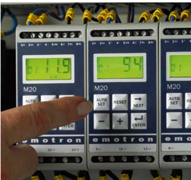
Emotron M20独特的自动设定功能可在3秒内设定4个保护设定点，仅需按单个按钮即可。
