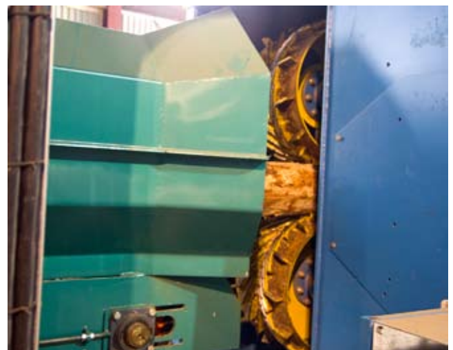
Snelle deceleratie bespaart waardevolle tijd. Een Emotron FDU-frequentieregelaar met een remweerstand stopt de invoer van boomstammen in ongeveer één seconde. Rotoren, die door Emotron MSF-softstarters worden aangestuurd, remmen in ongeveer 30 seconden af tot stilstand.
