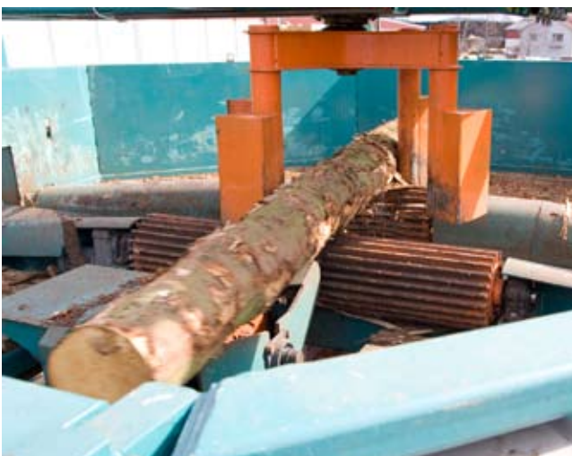
De boomstammen worden door een controleframe gevoerd, dat controleert of het smallere bovenuiteinde als eerste wordt uitgevoerd. De boomstammen die met het achteruiteinde naar voren liggen, worden in een draaimachine voor boomstammen omgedraaid.
