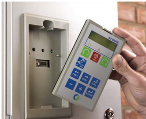
Abb. 1 Sie können das HCP anschließen, wenn Sie die Blindplatte oder das Bedienfeld entfernt haben.
