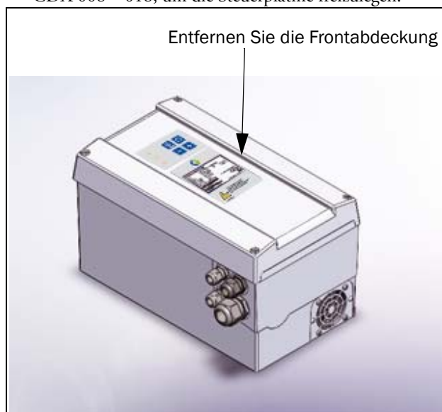
Abb. 4 Entfernen Sie die Fronabdeckung von Emotron CDU/CDX 008 - 018
