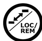
Diese Taste hat zwei Funktionen: Wechseln und Umschalten zwischen Vorort- und Fernsteuerung.
